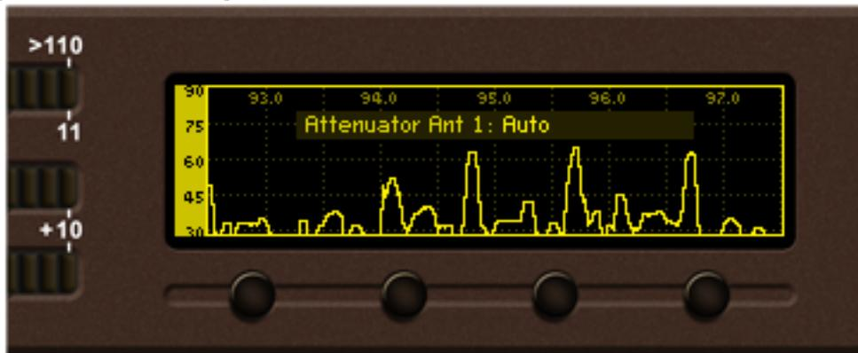
Start / Stop – используется для запуска или остановки процесса сканирования. Установка значения этого параметра в “Start” запустит процесс сканирования. Во время сканирования светодиодные индикаторы превращаются в стилизованный индикатор прогресса. Информация о ходе Bandscan также отображается в правом нижнем углу графика данных.
