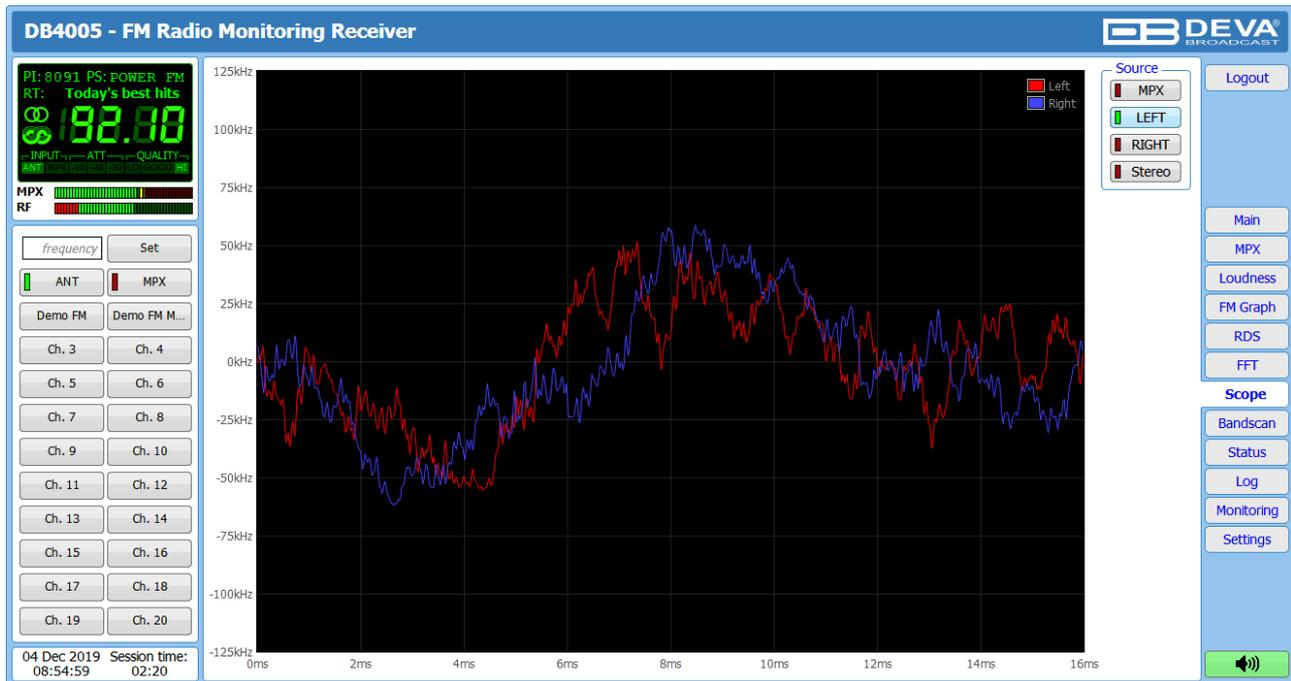
Экран осциллографа представляет сигналы, участвующие в процессе демодуляции и стереодекодирования с течением времени. Для изменения источника сигнала необходимо нажать соответствующую кнопку в правой части графика.
