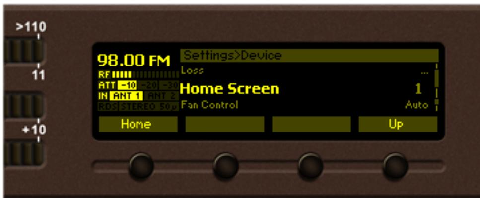
На главном экране по умолчанию отображается область заголовка ([см. “Область Заголовка” на стр.26](#)). Показаны также наиболее важные атрибуты флагов декодированного сигнала RDS (если таковой имеется) и большой индикатор текущей выбранной частоты. При нажатии любой из программно-зависимых кнопок будет установлен соответствующий предустановленный режим.
