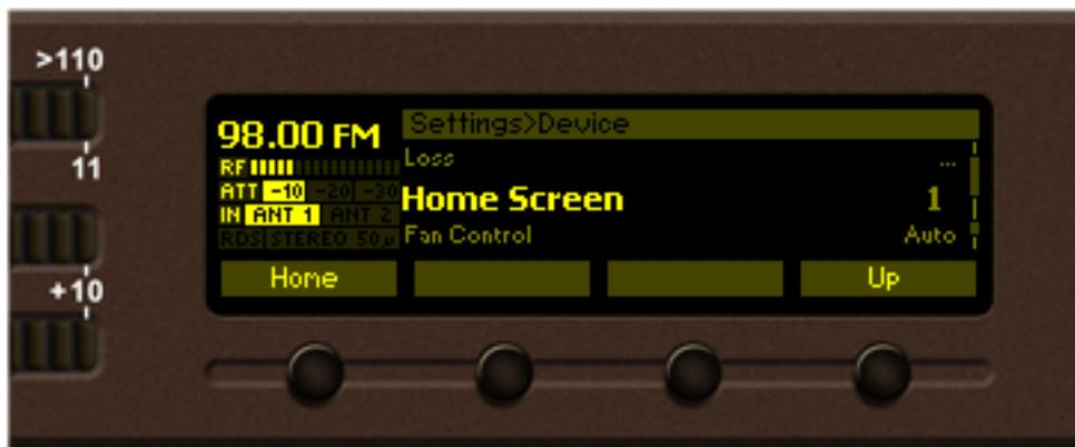
На главном экране по умолчанию отображается область заголовка ([см “Область Заголовка” на стр.26](#)). Показаны также наиболее важные атрибуты флагов декодированного сигнала RDS (если таковой имеется) и большой индикатор текущей выбранной частоты. При нажатии любой из программируемых кнопок будет установлен соответствующий предустановленный режим.
