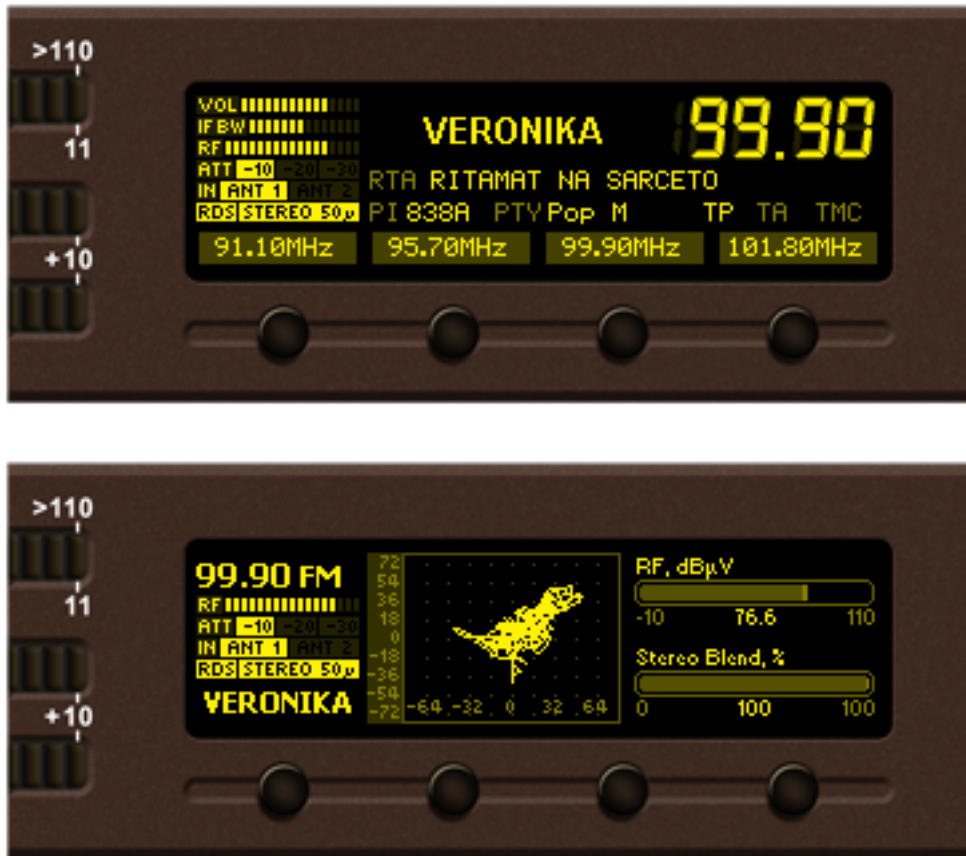
Pantalla OLED con sus áreas de función
